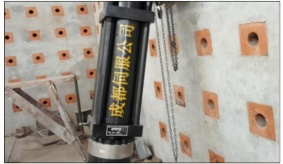
图 12 1000kN 电液伺服作动器
