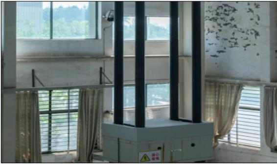
图 11 10000kN 长柱压力机
