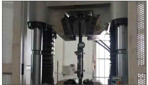
图 14 SANS 万能材料试验机
